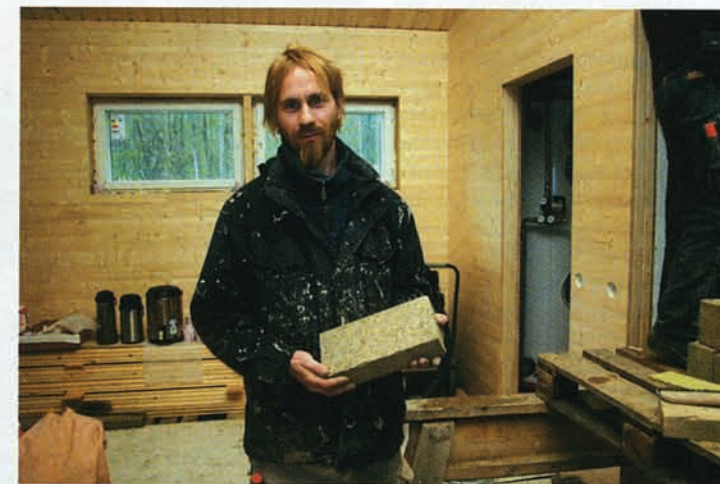
"SAVITIILI on polttamaton, kuivaksi puristettu tiili, jonka kosteusprosentti on ainoastaan 2,5", sanoo rakennuskonservattori Teemu Kuivalainen. Tiili kestää käsittelyn erittäin hyvin.
